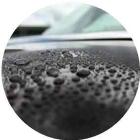
**NanoX150<sup>®</sup> Xeramic** es resistente al agua después de 24 horas y desarrolla su resistencia completa contra la abrasión mecánica y los productos químicos después de 7 días. Una reducción del tiempo de secado es posible, por ejemplo. Con un calentador infrarrojo a una temperatura de la superficie a 80°C durante un período de 30 minutos. Mediante este procedimiento, el tiempo de secado se reduce a solo 3 horas.
