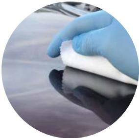
La mejor manera de realizar la aplicación es girando suavemente en círculos para evitar cualquier exceso visible. Este paso, si se requiere, puede repetirse hasta 3 veces a intervalos de 5-10 minutos para aumentar el grosor de la capa.
